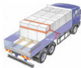
Figura 40: ancoraggio antirimbalzo tramite imbracatura
