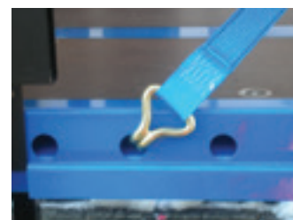
Figura 13: foro di ancoraggio nel profilo laterale
